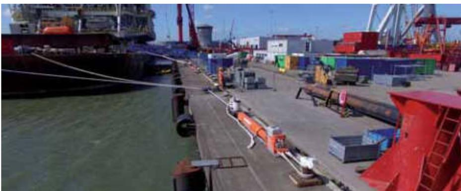
Figura 3. Dispositivo de amarre hidráulico Shore-Tension
