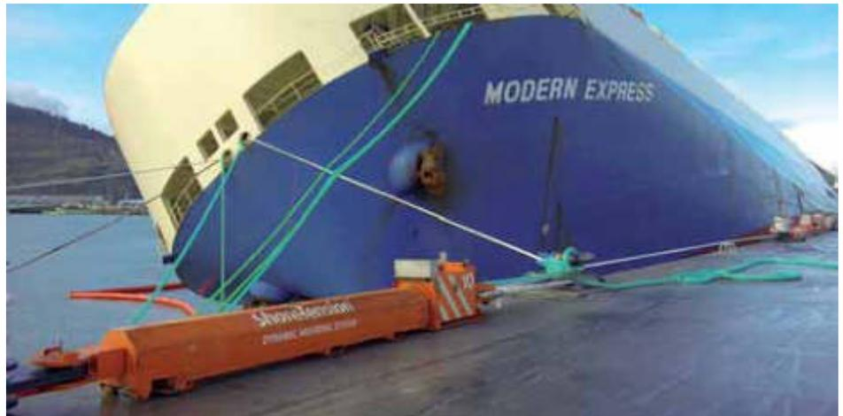
Figura 4. Dispositivo de amarre hidráulico en Bilbao
